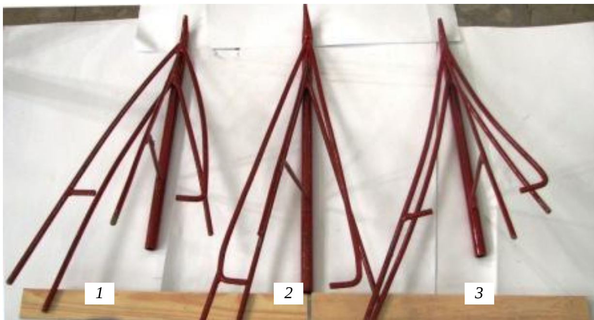
Рис. 3.10- Подільники з формою бічного прутка: 1 – опуклою; 2 – прямолінійною; 3 – вгнутою
