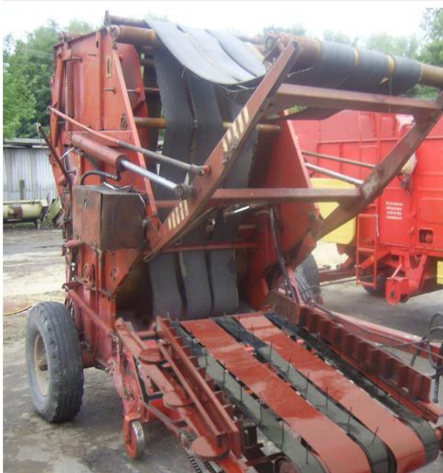
Рис. 3.33 - Фото пристрою для підрівнювання стрічки стебел льону ( a ) та прес-підбирача ПРП-1,6 з підрівнюючим пристроєм ( б )
