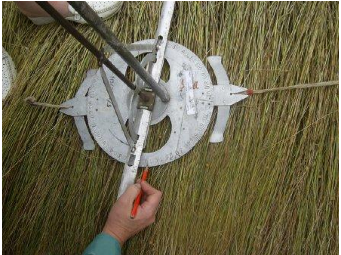
Рис. 3.11- Визначення кута відхилення стебел у стрічці
