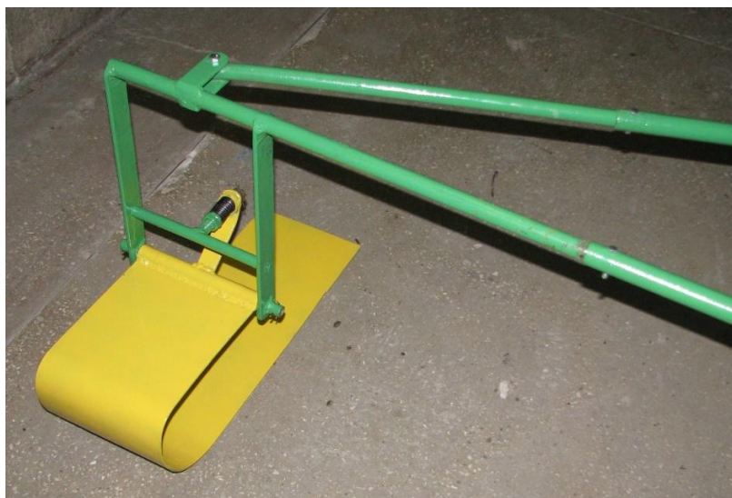
Рис. 5.11 - Конструкції притискачів стрічки льону: а – з пасовим притискним пристроєм; б – з пластинчатим притискним пристроєм
