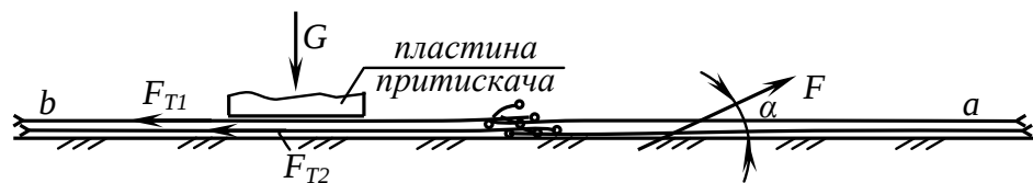
Рис. 5.2- Схема сил, що діють на стебла, при виконанні операції обертання стрічки обертачем, обладнаним притискним пристроєм
